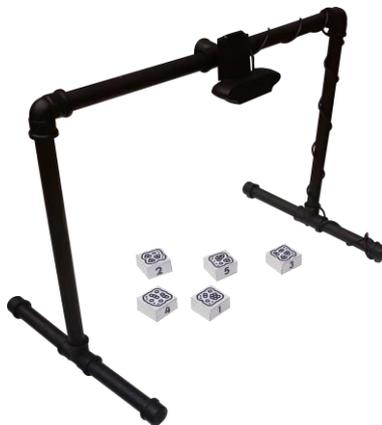
Figura 11: Estrutura desenvolvida para a utilização do *ReactIVision*.
