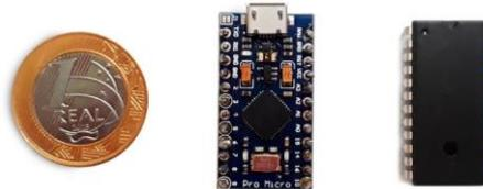
Figura 9: Da esquerda para direita: moeda de Um Real (para dar a noção de escala); Arduino Pro Micro Leonardo e circuito integrado cd4067.
